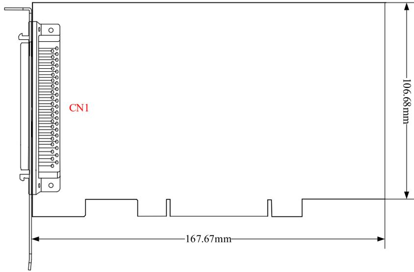
图 3-2-2 PCI237X 尺寸图
