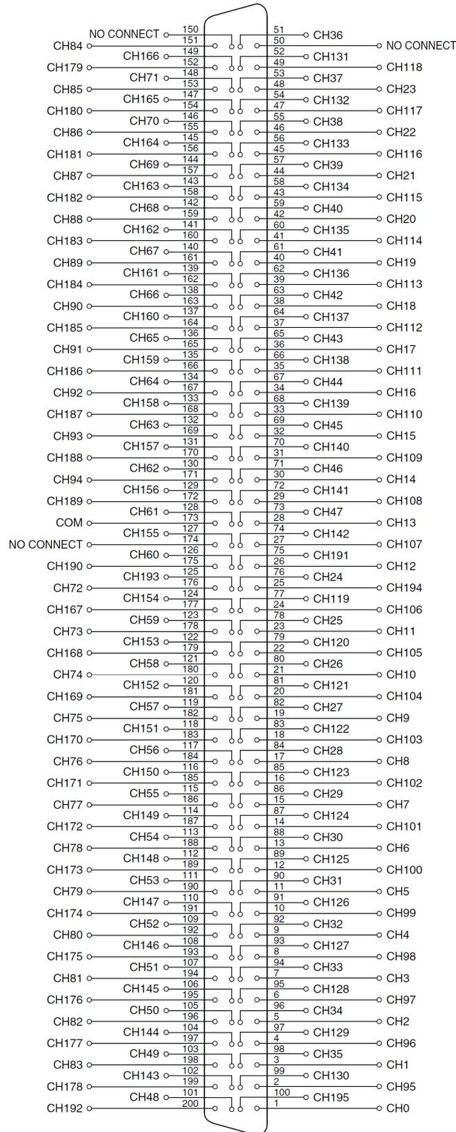
图 3-2-1 1 线 196×1 拓扑连接器引脚定义
