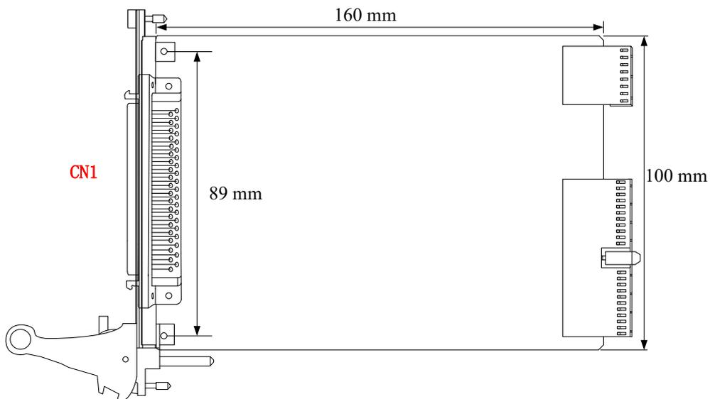
图 3-1-2 PXI2625 尺寸图
