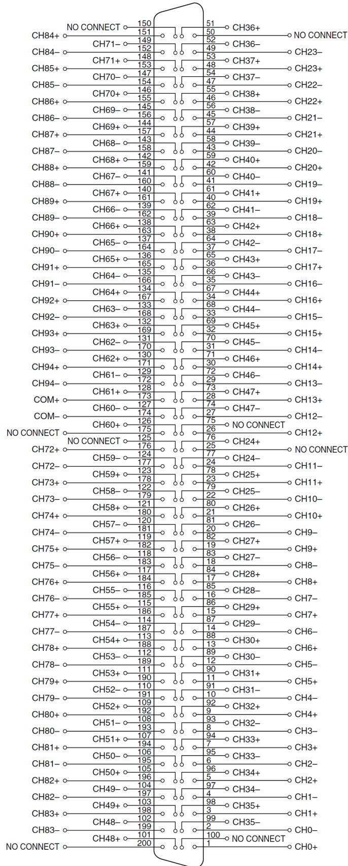
图 3-2-2 2 线 95×1 拓扑连接器引脚定义
