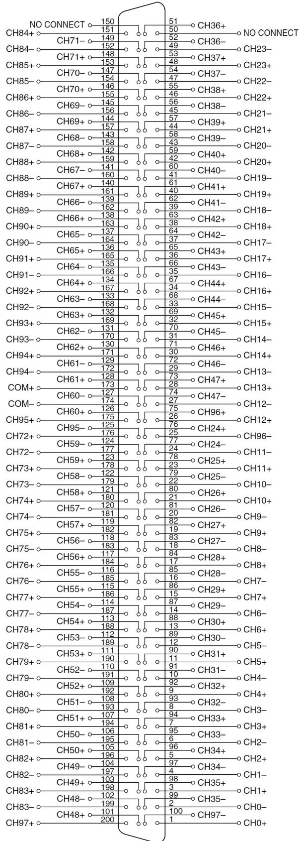
图 3-2-3 2 线 98×1 拓扑连接器引脚定义
