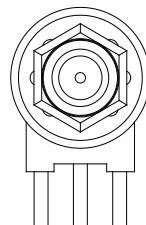
PXI触发连接器用于路由外部触发信号。触发信号可兼容TTL。PXIe7682控制器提供四种触发模式来同步PXI模块，包括：
