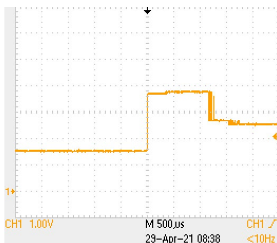
图 4-4-4 先断开后闭合的动态变化
