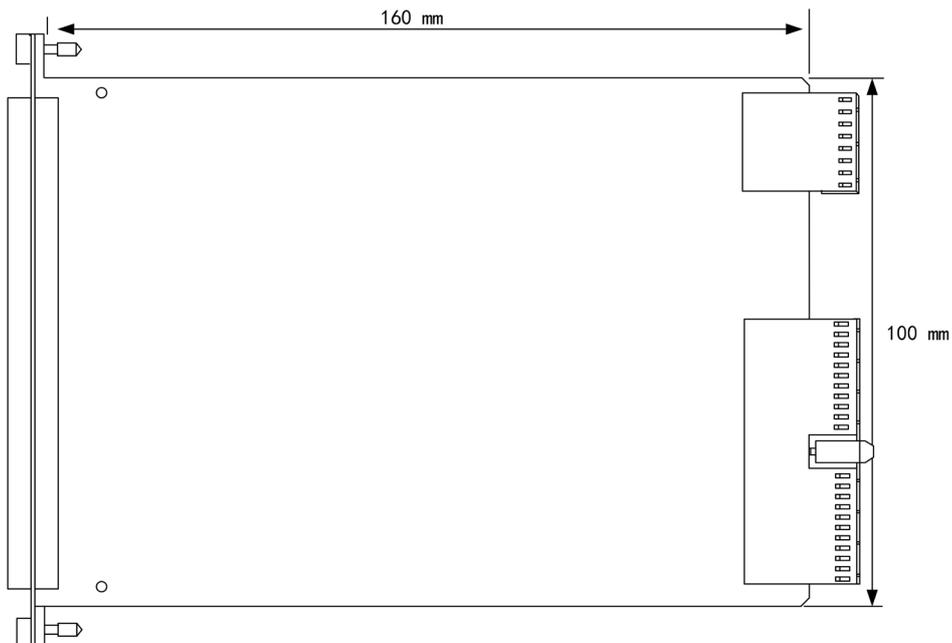
图 3-1-2 PXI2603 尺寸图
