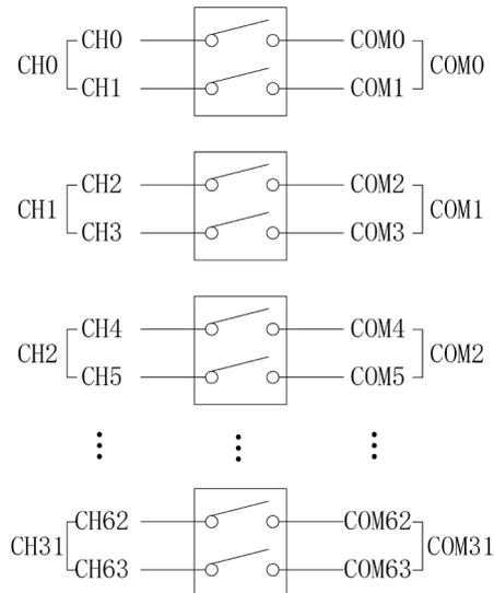
图 2-2-2 32 通道双刀单掷通用开关拓扑图（配合 TB2603）
