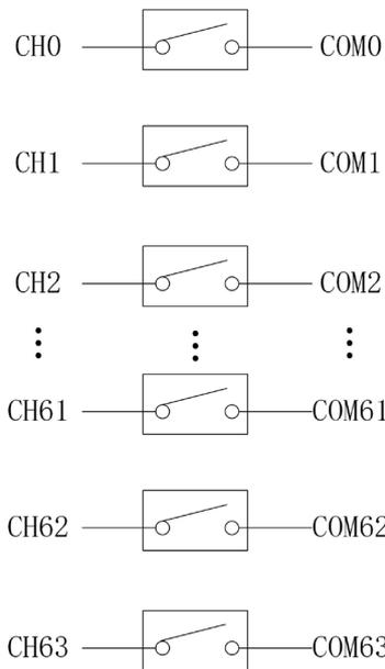
图 2-2-1 64 通道单刀单掷通用开关拓扑图（配合 TB2603）
