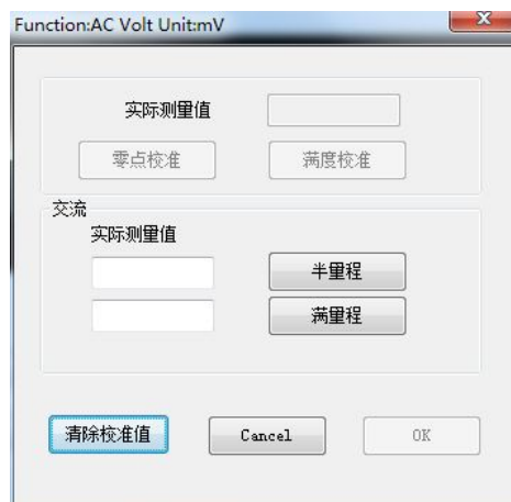
图 4-9-3 交流电压、电流校准
