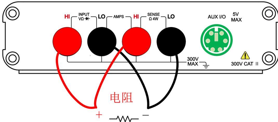
图 3-7-1 4W 电阻测量接线方式
