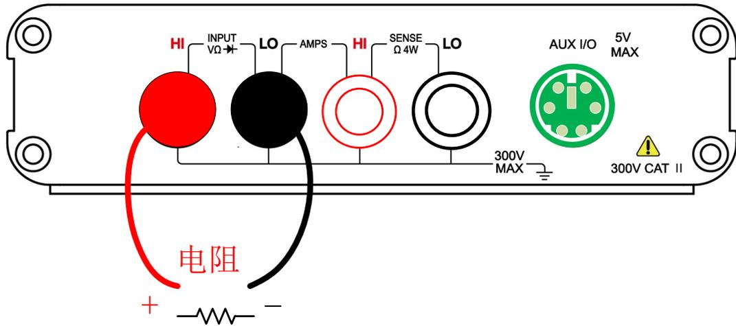
图 3-6-1 2W 电阻测量接线方式
