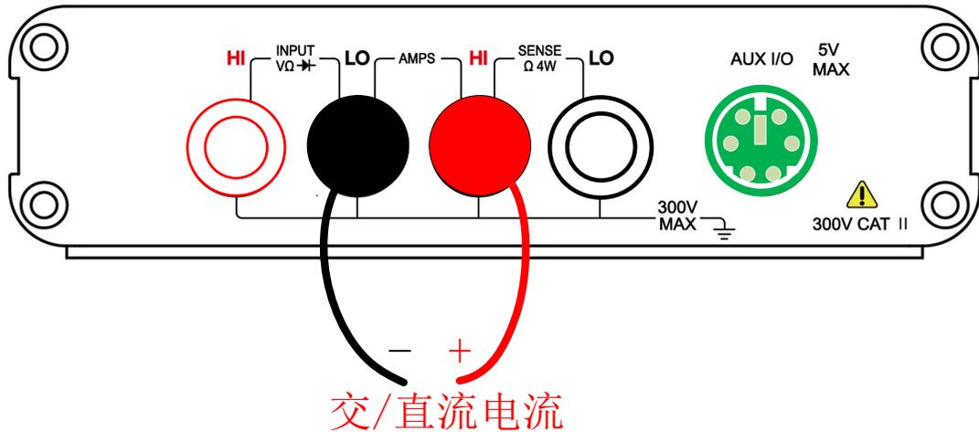
图 3-8-1 测量交、直流电流接线方式
