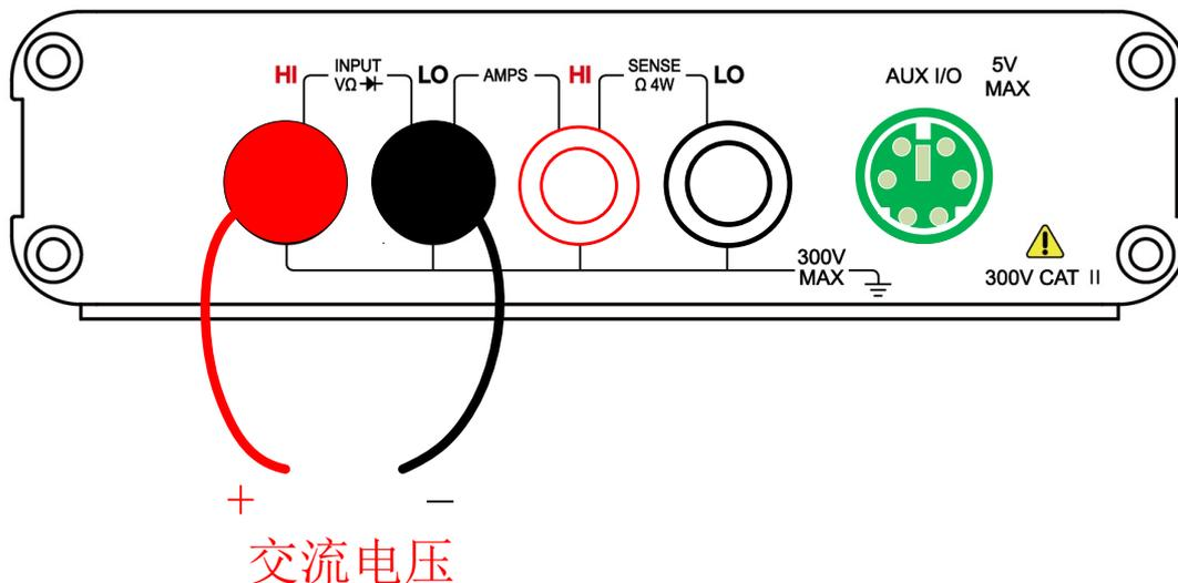
图 3-1-2 测量交流电压接线方式
