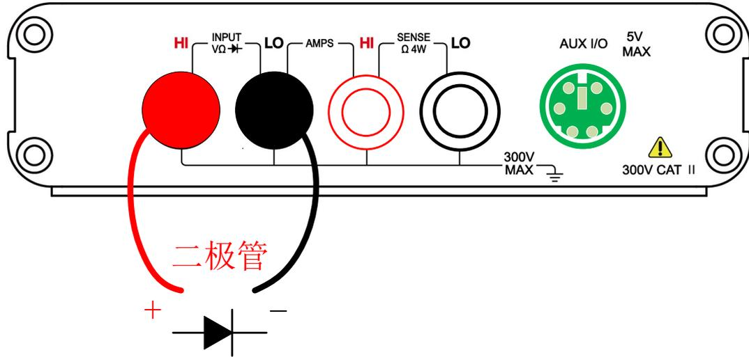
图 3-4-1 二极管测量接线方式
