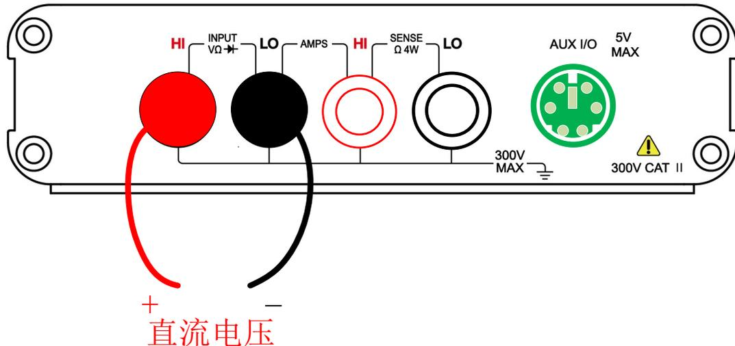
图 3-2-1 测量直流电压接线方式
