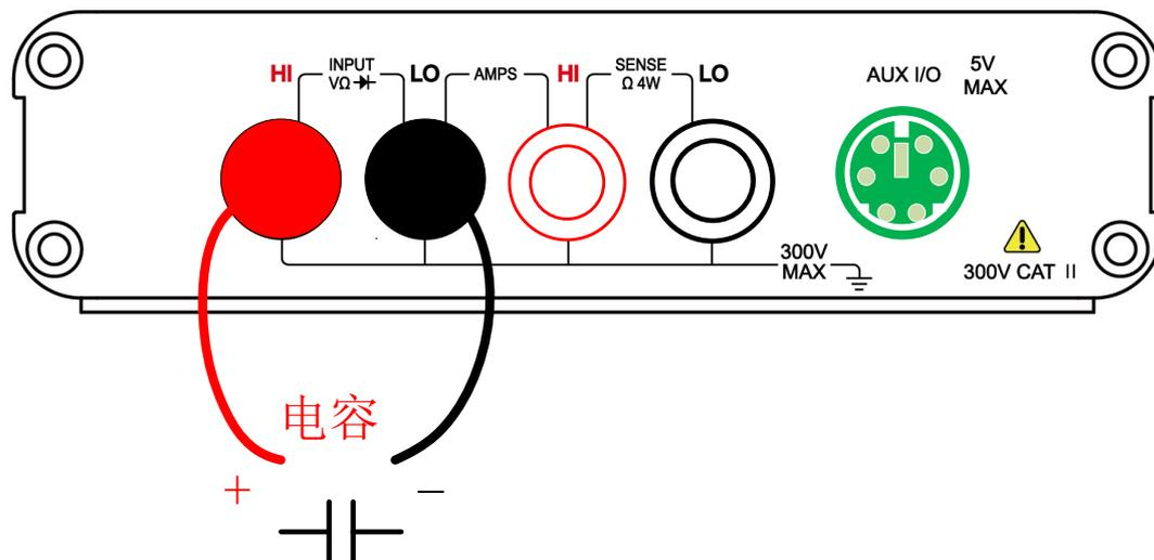
图 3-5-1 测量电容接线方式
